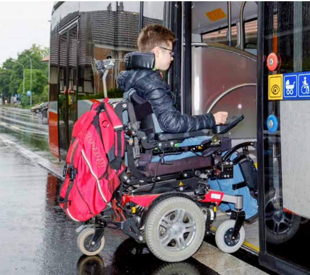
Le Canton de Berne a finalement consenti à construire le «Sonderbord Plus» avec une bordure arrondie en dessous, permettant au bus de se positionner proche du bord.
