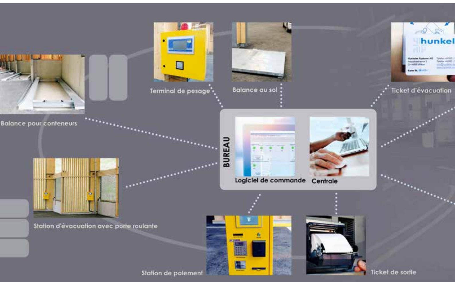
Les balances de la déchetterie de Develier (JU) sont gérées automatiquement.
