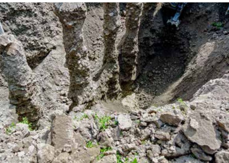
Abb. 3: Freilegung der sechs NDJ-Pfähle bis unter den Grundwasserspiegel. Rechts: Verlauf des pH-Werts (Fehlerindikator ±2%) während 10 Stunden nach Pfahleinbau, Richtwert von 8,2 gemäss Eidgenössischem Departement des Innern (EDI), Bern (TBDV, 2016, Stand 2018).
