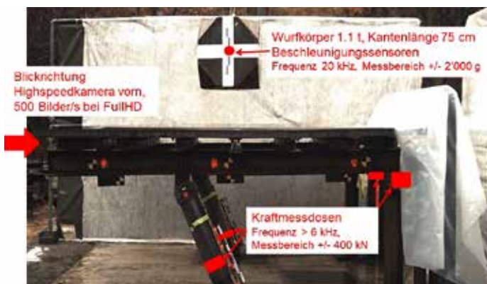
Seitenansicht Versuchsaufbau und Messtechnik für vertikale Fallversuche.
