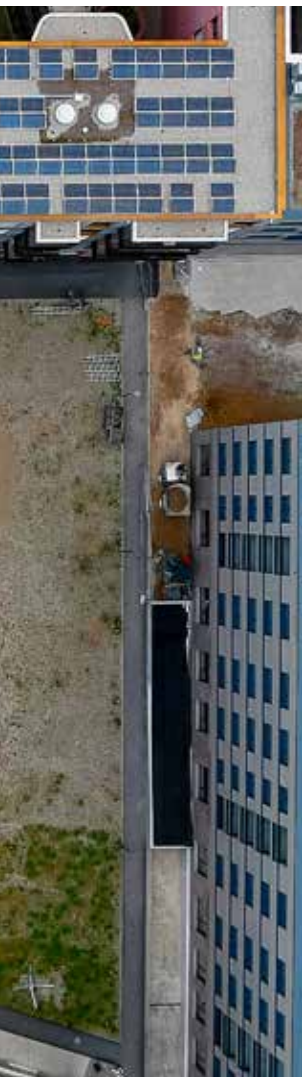
Die Dächer der 13 Gebäude der Überbauung Erlenmatt Ost in Basel werden mit Photovoltaik-Modulen ausgerüstet. Diese produzieren über das Jahr fast ein Drittel so viel Strom, wie die 200 Haushalte auf dem Areal einschliesslich Heizung, Warmwasser und Betrieb von zwei Mieteletromobilen brauchen.
