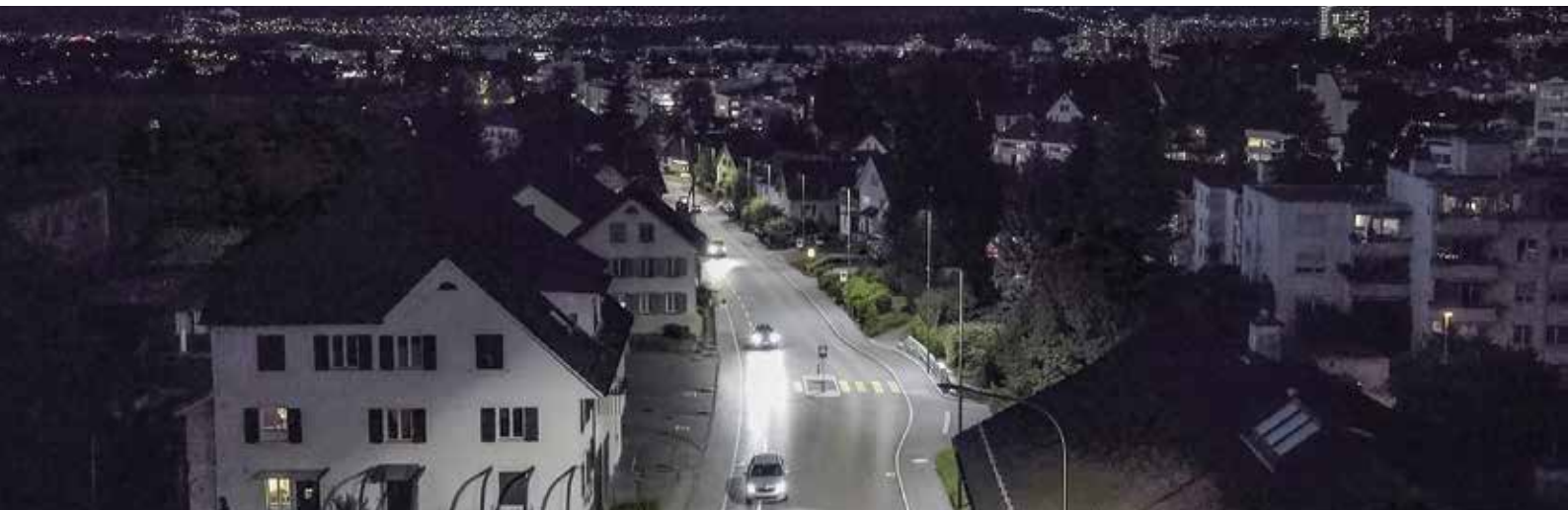
In der Zürcher Agglomerationsgemeinde Urdorf schwankt das Verkehrsaufkommen je nach Tages- oder Nachtzeit stark. In der Ortsdurchfahrt passt sich die Lichtstärke auf einer Länge von einem Kilometer dynamisch dem Verkehrsaufkommen an.
