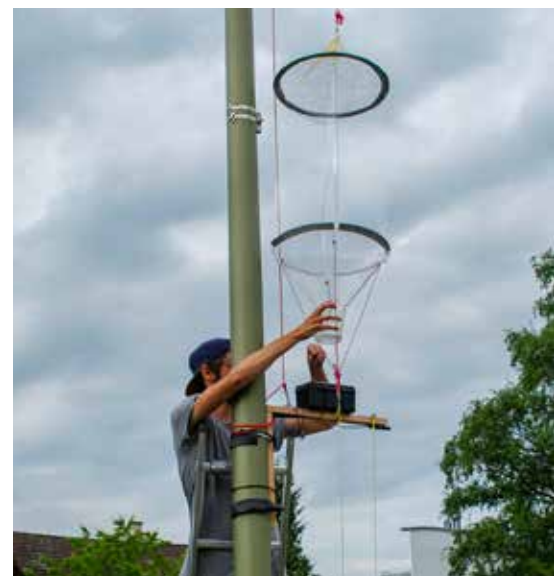
Die Insektenfalle wird am Morgen hinuntergelassen. Der Auffangbecher mit den Insekten wird entnommen. Das schwarze Gerät unter der Falle zeichnet die Fledermausrufe im Ultraschallbereich auf. Bild: Katia Soland
