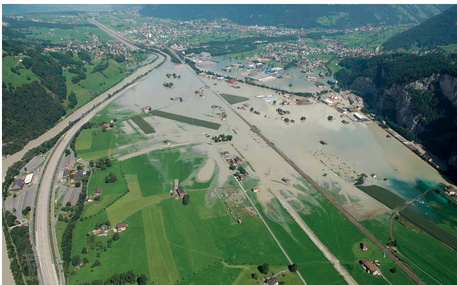
Une crue débordante, contenue seulement par les limites physiques inscrites dans le territoire soit, à gauche, la chaussée légèrement surélevée de la route et, à droite, l'épaulement d'une colline. (Photos/Illustration: B+C Ingénieurs)
