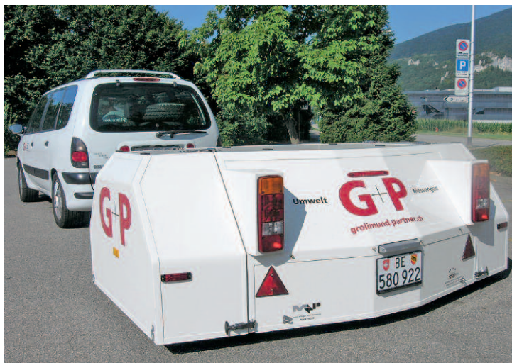
Dieser Spezialanhänger der Grolimund & Partner AG misst den Strassenlärm mittels Mikrofonen und anderen Messgeräten.
