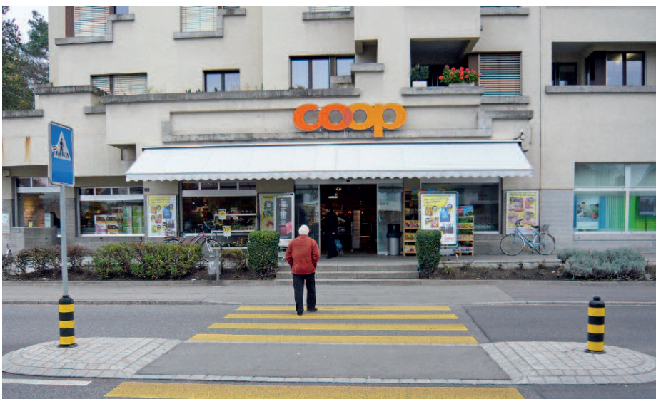
Bassersdorf: Der Fussgängerstreifen – mit Mittelinsel – ist auf der Wunschlinie angelegt. Hier sind keine Umwege nötig.
