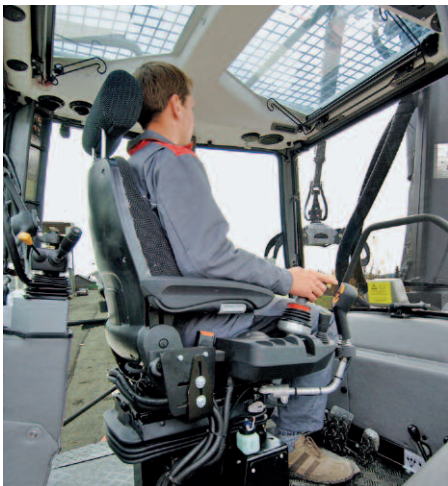
Der elektrisch drehbare Sitz mit integriertem Joystick im neuen Steyr-CVT-Trac Kommunal. (Bilder: zvg)
