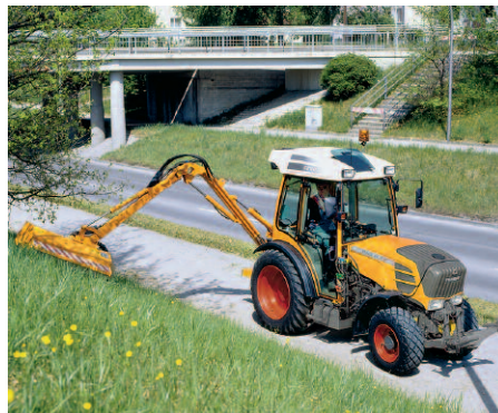
Der Fendt Vario200 verfügt über ein stufenloses Getriebe und eine verschleissfreie Wendeschaltung.
