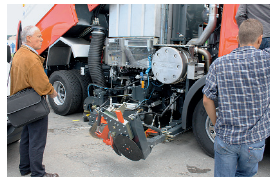
Effizientes Abrandgerät: Der Fahrer hat es über Spiegel und Kameras im Griff.
