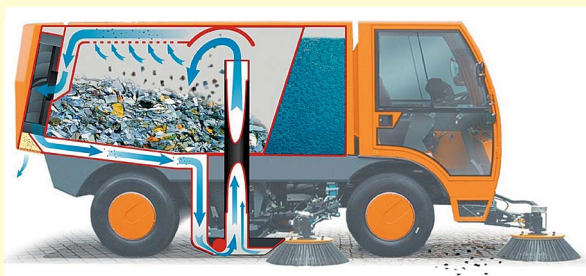
Aebi-MFH-Kehrmaschinen basieren auf einem geschlossenen Umluftsystem.
