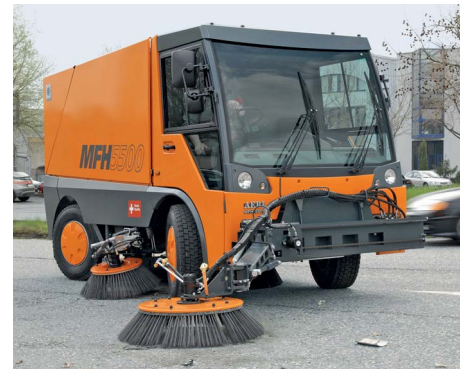
Der neue Aebi MFH 5500 wird von einem umweltfreundlichen Iveco-Turbo-dieselmotor (Euro 4) angetrieben.
