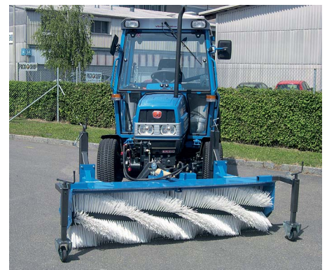
Frontkehrbürsten wie an diesem Iseki TK 538 angebaut werden immer mehr auch für den Winterdienst eingesetzt.
