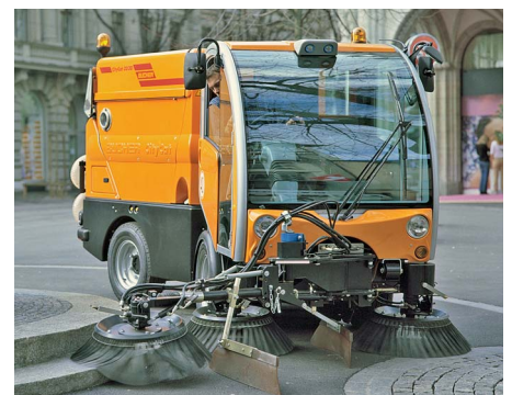
Die extrem wendige und leistungsfähige CityCat von Bucher-Schoerling – hier das Modell 2020 mit Knicklenkung.
