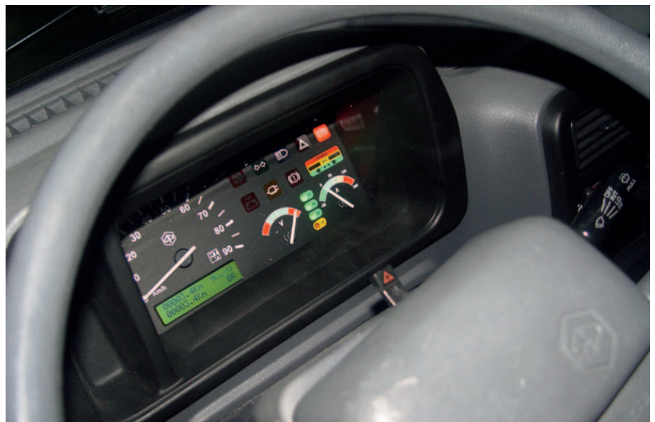
Kein Tourenzähler und keine Benzinanzeige – das Armaturenbrett des mit einem kräftigen und umweltfreundlichen Elektromotor ausgestatteten Piaggio Porter.
