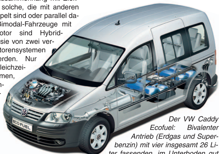
Der VW Caddy Ecofuel: Bivalenter Antrieb (Erdgas und Superbenzin) mit vier insgesamt 26 Liter fassenden, im Unterboden gut verborgenen Gastanks im Unterboden und einem elf Liter grossen Tank für Superbenzin.
