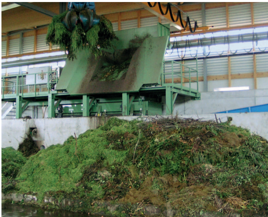
Der Fermenter einer Vergärungsanlage wird beschickt. Die kontinuierliche Versorgung mit Material gewährleistet eine konstante Gasproduktion. (Bild: Kompogas AG)
