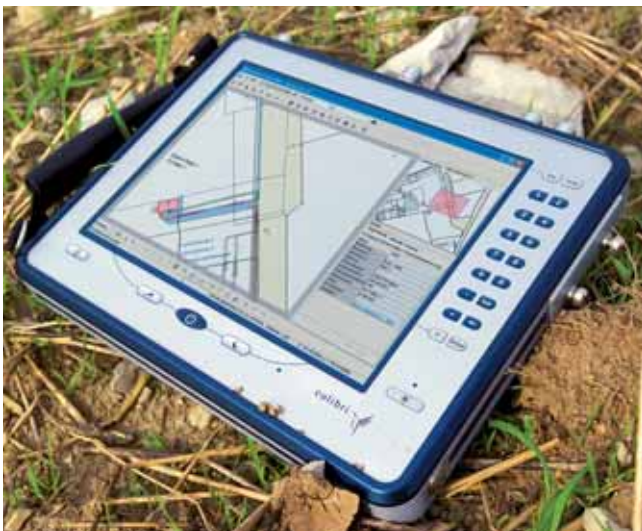
In der Stadt Bern kommen bei der Schlammsammlerkontrolle ein «colibri» von Mettenheimer und ein externer GPS-Navigationsempfänger zum Einsatz.
