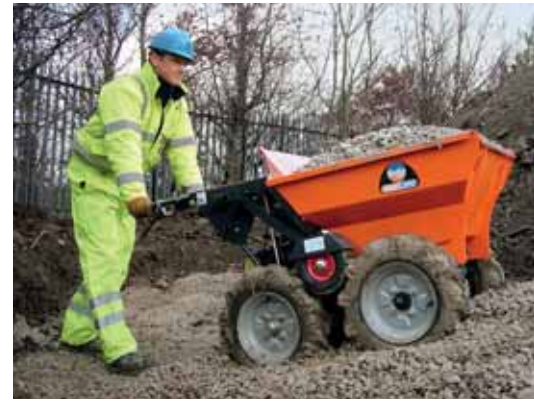
Minidumper Belle BMD300: 4x4-Antrieb, 300 kg Nutzlast, mit Kipper oder Pritsche.
