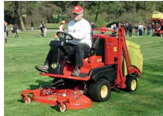
Gianni Ferrari GT: neuer, schlanker Frontmäher mit hydraulischem, 126 cm breiten Frontmähwerk.
