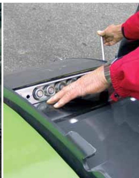
Der Egholm 2200: Einfach ins Anbaugerät «ineschlüffe» und mit einer einzigen Handbewegung alle Schläuche festsetzen.
