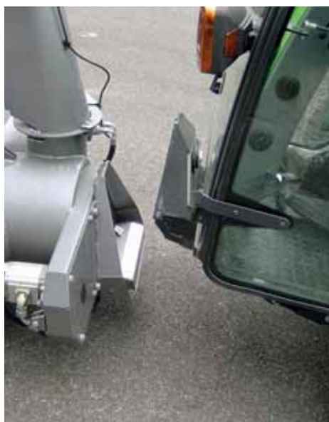
Der Egholm 2200: Einfach ins Anbaugerät «ineschlüffe» und mit einer einzigen Handbewegung alle Schläuche festsetzen.
