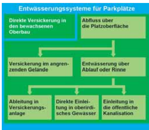
Übersicht über die Entwässerungssysteme.
